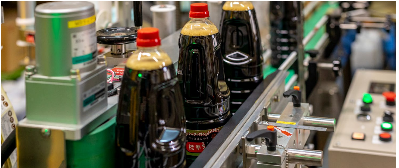
■ペットボトルに対応できるよう「タックラベラー」が導入された、製造工程のラベル貼り部分
