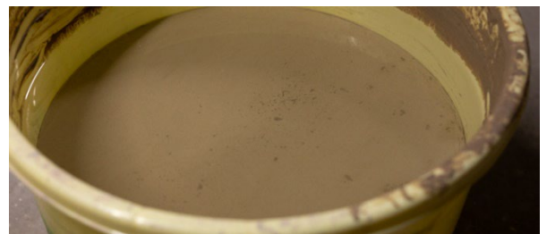
■ 貝灰など地元の素材を原材料に使った釉薬。釉薬の成分によって、焼き物の表面の色が変わる
