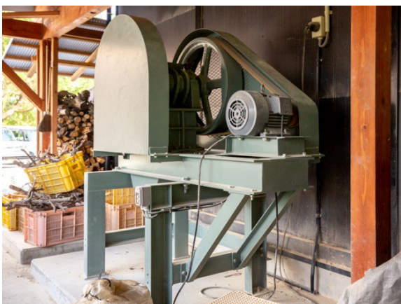
■補助金で導入し、東温市の工房に設置した「圧縮粗砕機」
