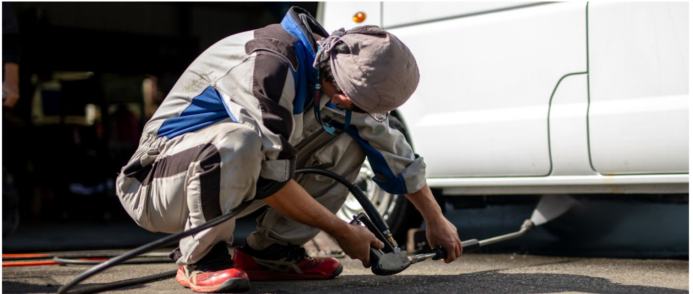
■車両下回りの洗浄の様子。ブラシを使っていたときと比べ、作業時間も肉体的負担も大幅に改善した
