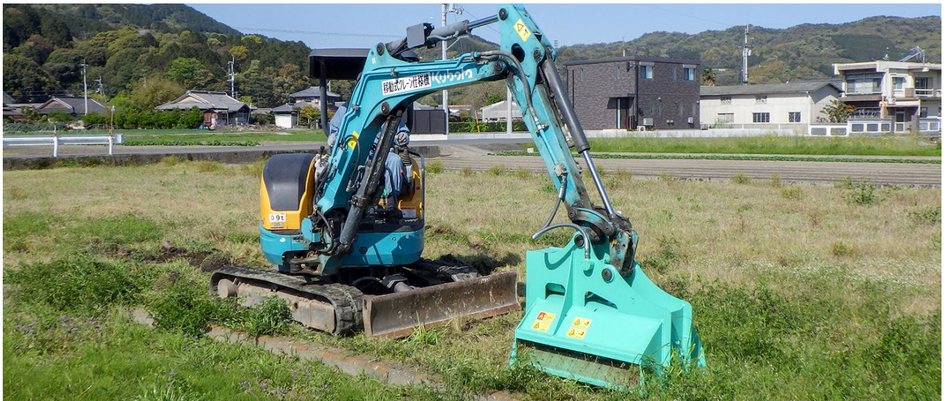
■ 「草刈り用アタッチメント」を装着した小型ユンボ。アタッチメントが圧倒的なスピードとパワーで雑草・雑木を粉砕する
