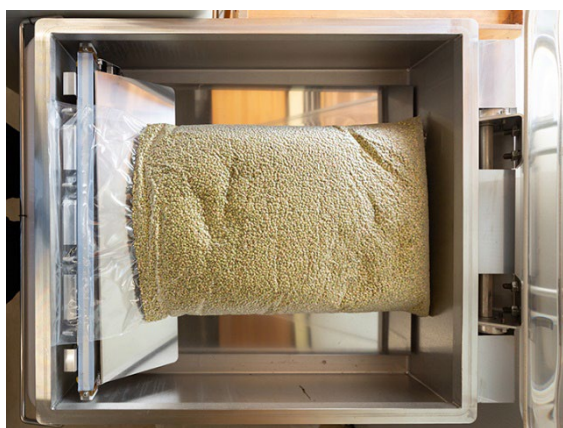
■食材の中の酸素まで抜けるチェンバー式の「真空包装機」
