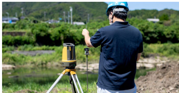
■「ワンマン測量」の設定の様子。プリズムの位置を測量機に認識させている
