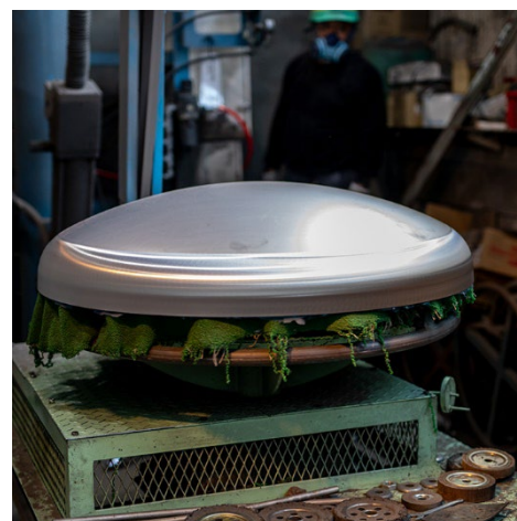
■ステンレスタンクの端面に使われている鏡板（かがみいた）
