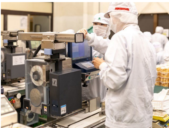
■ 「新型自動ラベル貼り機」の位置調整の様子。旧型モデルよりも調整が容易で、清掃もしやすい
