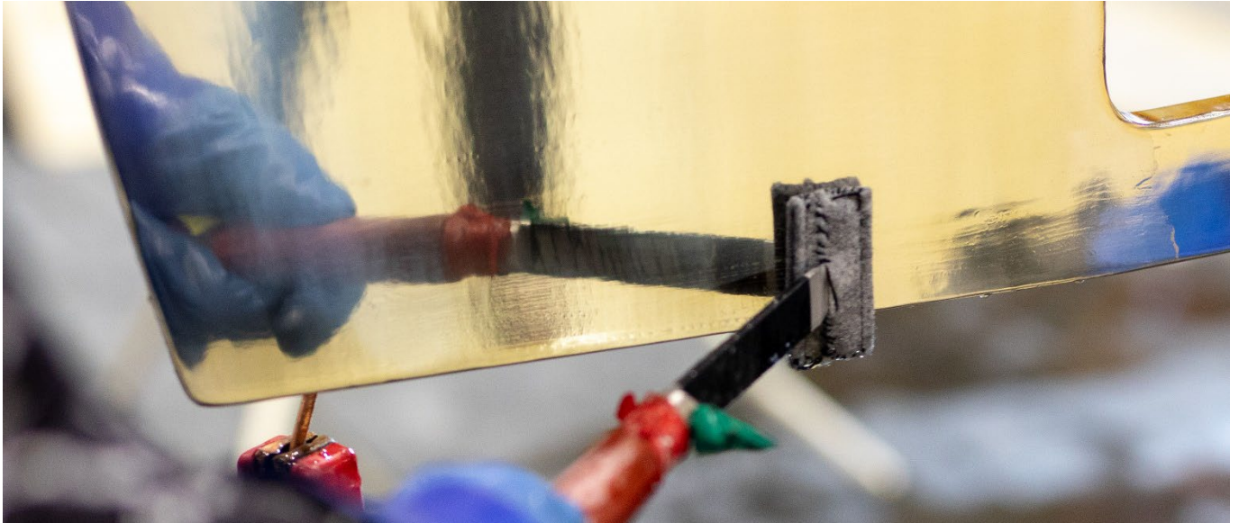
■手動式隔膜電解研磨法による表面処理。ステンレス表面に腐食に強い被膜を形成して、ステンレス材を美しく長持ちさせる
