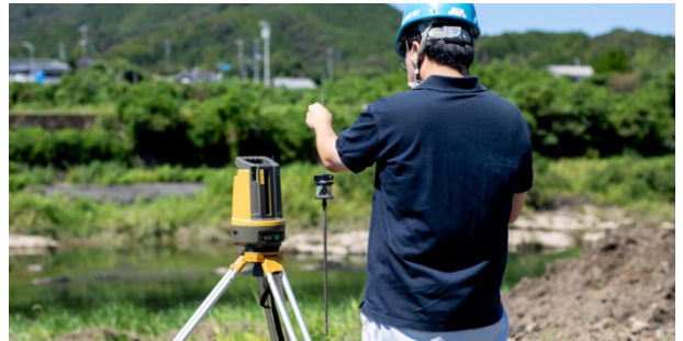
■「ワンマン測量」の設定の様子。プリズムの位置を測量機に認識させている
