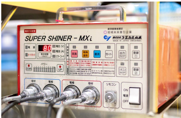
■今回導入したステンレス溶接焼け取り電源機
